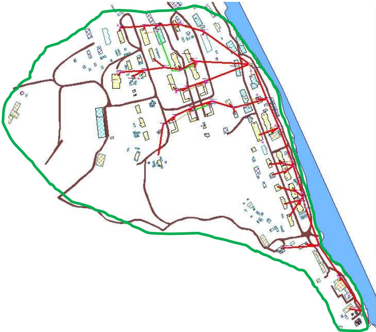
*Рисунок 1.4.8.1 - Границы планируемых и существующих зон размещения объектов централизованной системы производственно-бытовой канализации*
