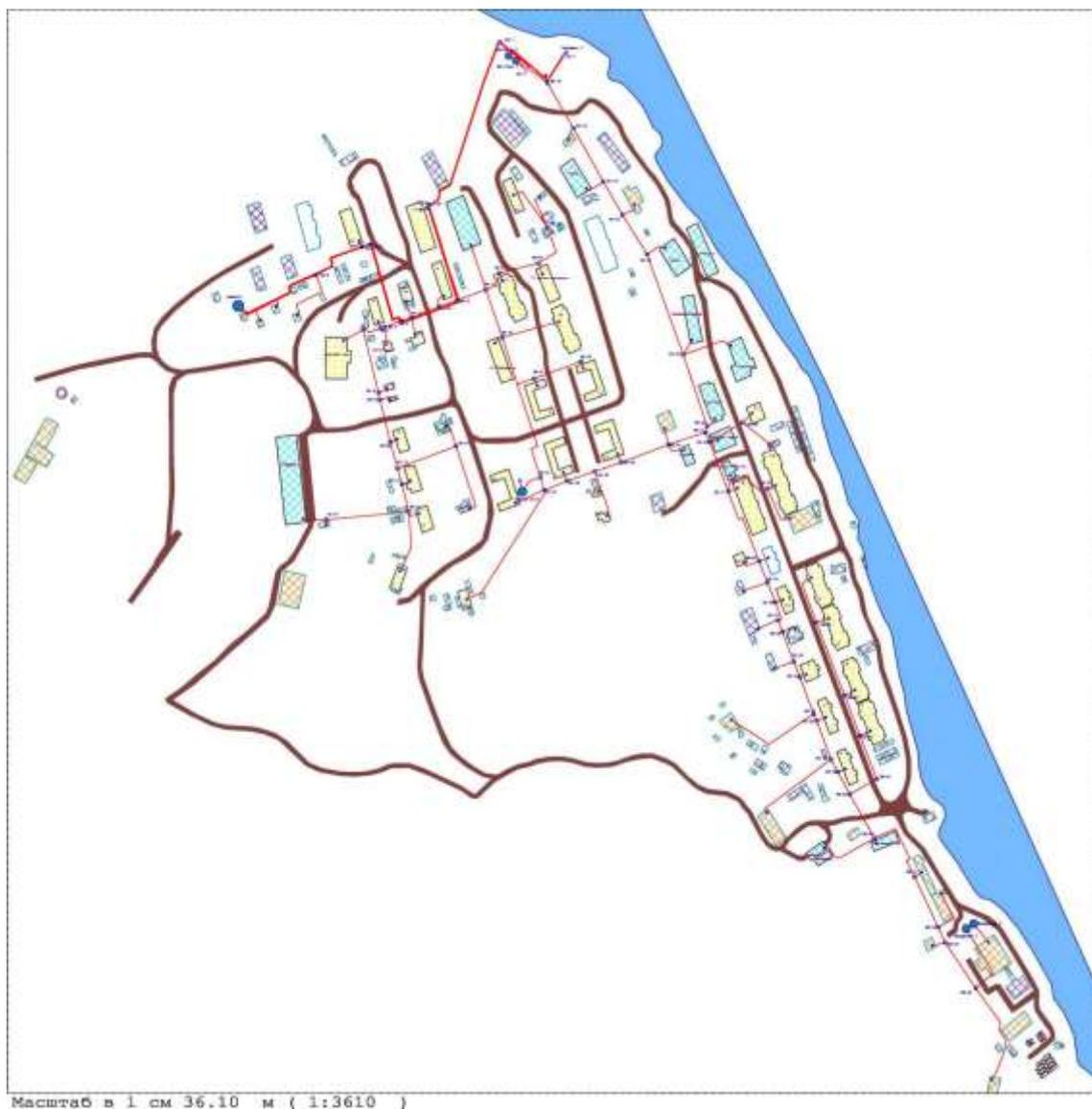
*Рисунок 1.1.1.2 – графическое изображение системы водоснабжения*
