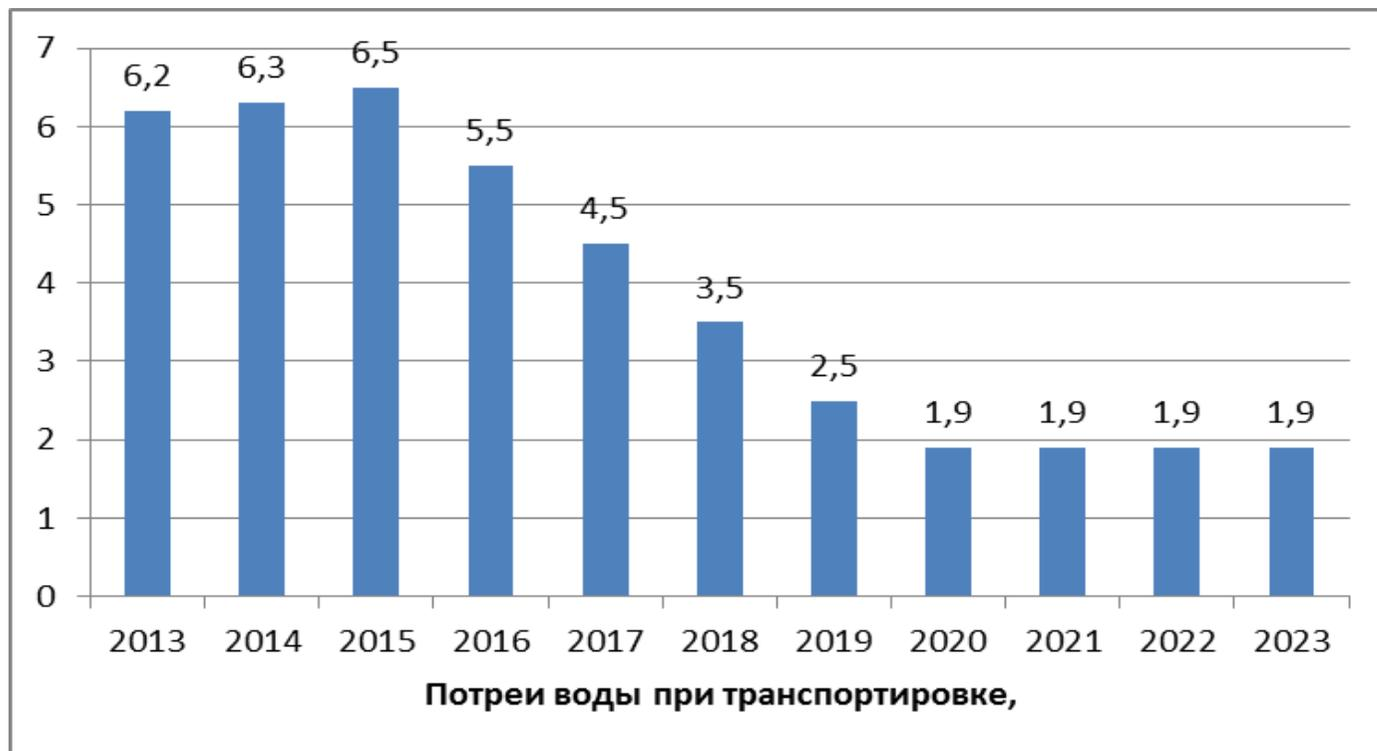
*Рисунок 1.3.12.1 – Динамика потери питьевой воды при транспортировке*
