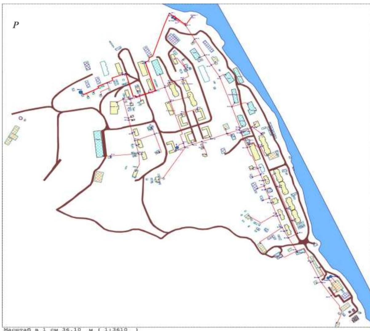
*Рисунок 1.4.6.1.– Трассировка сетей водоснабжения*
